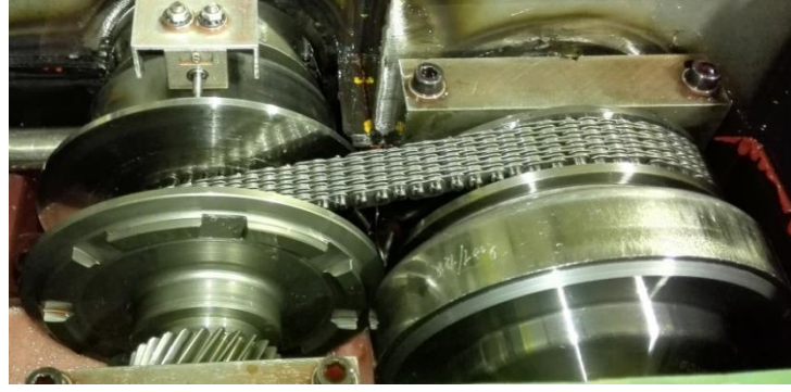
Şekil 3.28. Deney düzeneğinde kullanılan zincirli SDA Sistemi
