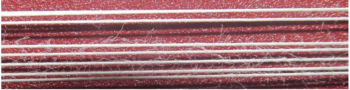
Şekil 4.9. Kontinü filament PES ile kaplanmış kompozit ipliğin aşınma sonrası görüntüsü
