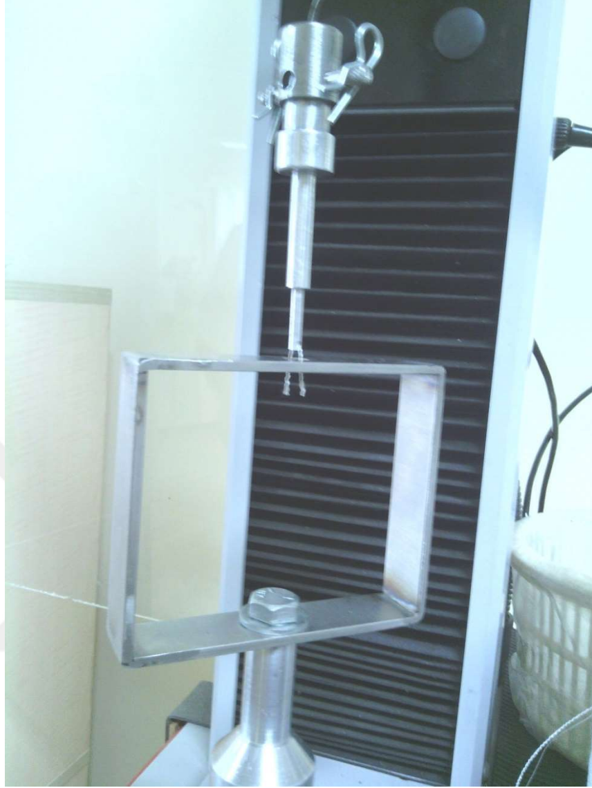
Şekil 3.7. Coats Technology Center stiffness testi çalışma prensibi (COATS Türkiye İplik Sanayi A.Ş.)
