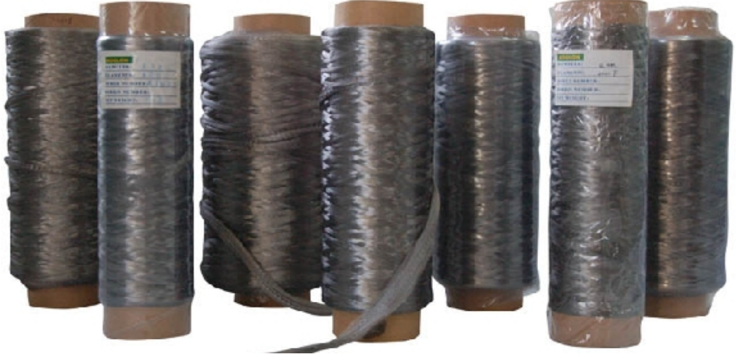
Şekil 2.3. Demet çekim yöntemi ile elde edilen metal lif ( http://www.koolonfiber.com/en/Product_info.php?id=7 , 2014)
