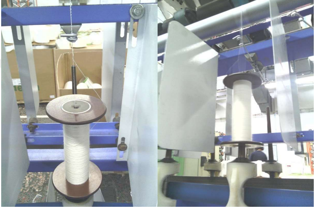
Şekil 3.3. S&Z (MX) Covering Makinesinin Sarım Prensibi
