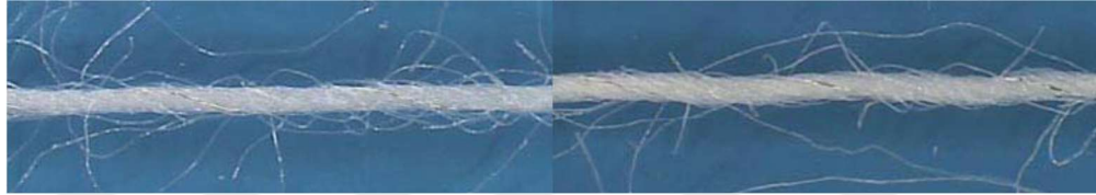
Şekil 2.14. Çekirdek bükümlü ipliğin mikroskop altındaki görüntüsü (Derdiyok 2007)
