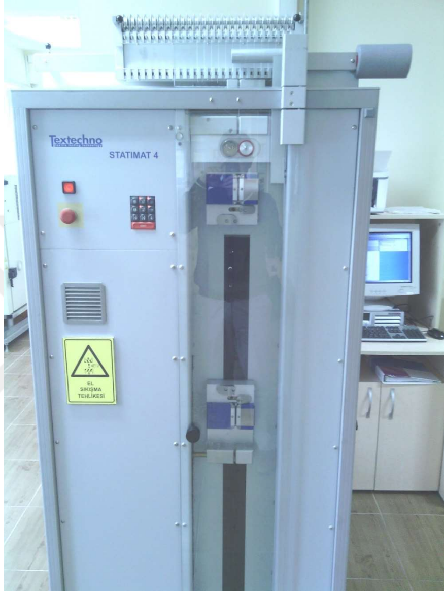
Şekil 3.4. Textechno Statimat 4 kopma mukavemeti ölçüm cihazı (COATS Türkiye İplik Sanayi A.Ş.)
