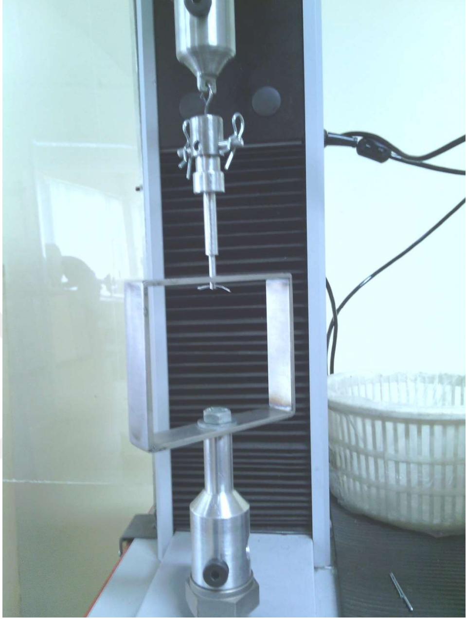
Şekil 3.6. Coats Technology Center stiffness testi (COATS Türkiye İplik Sanayi A.Ş.)
