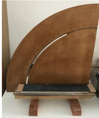
Şekil 3.6. Yuvarlanma açısı belirleme düzeneği
