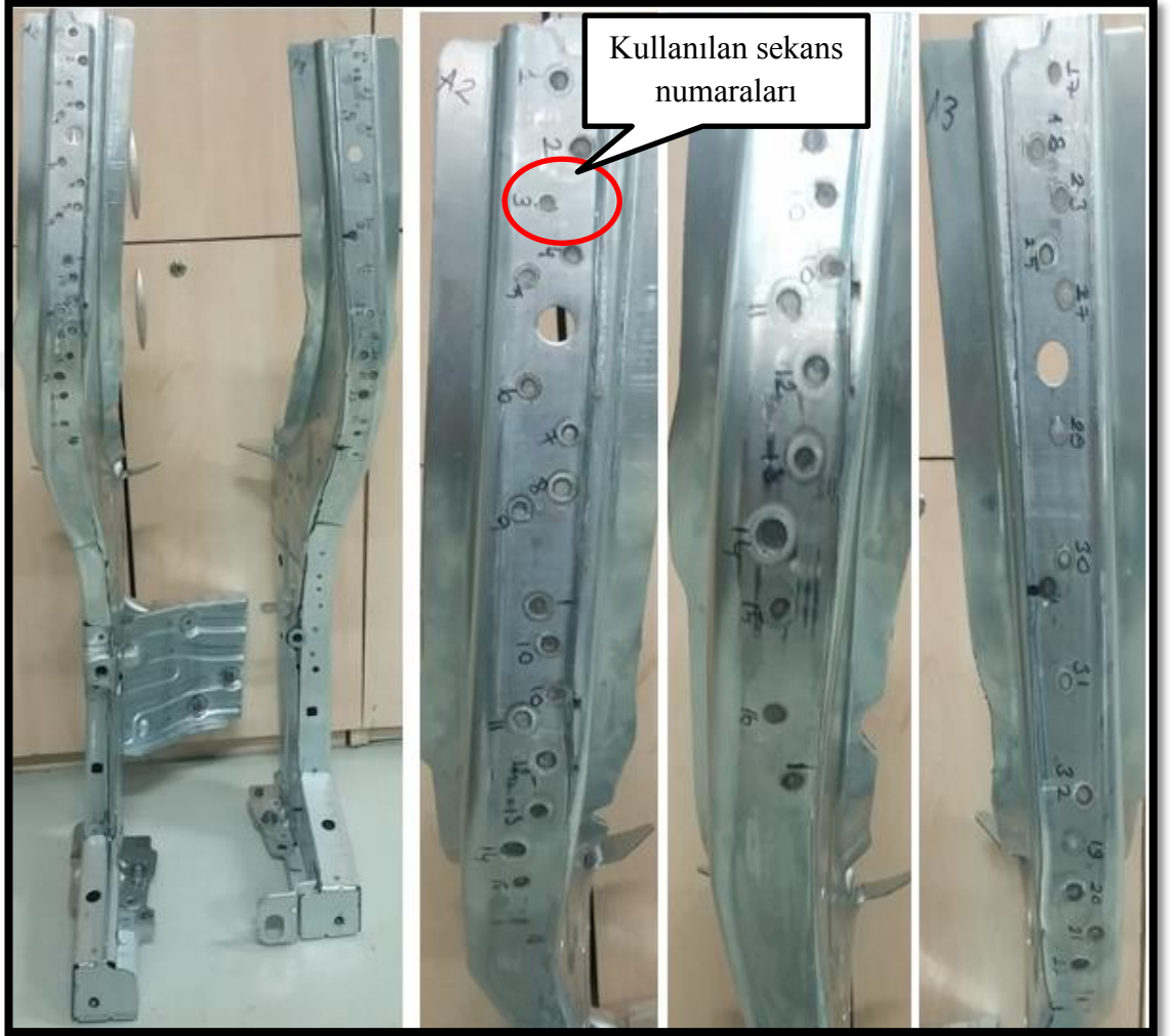
Şekil 5.1. Tahribatlı kontrol öncesi 32 deneyin uygulandığı deney numuneleri
