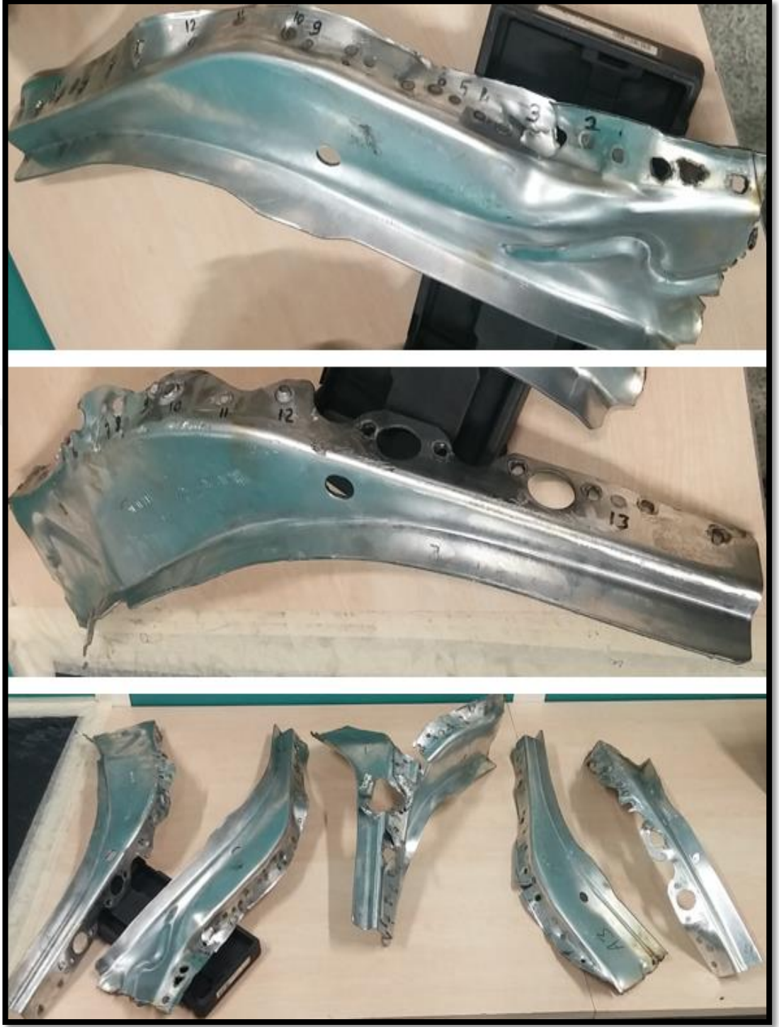
Şekil 5.2. Tahribatlı kontrol sonrası 32 deneyin uygulandığı deney numuneleri
