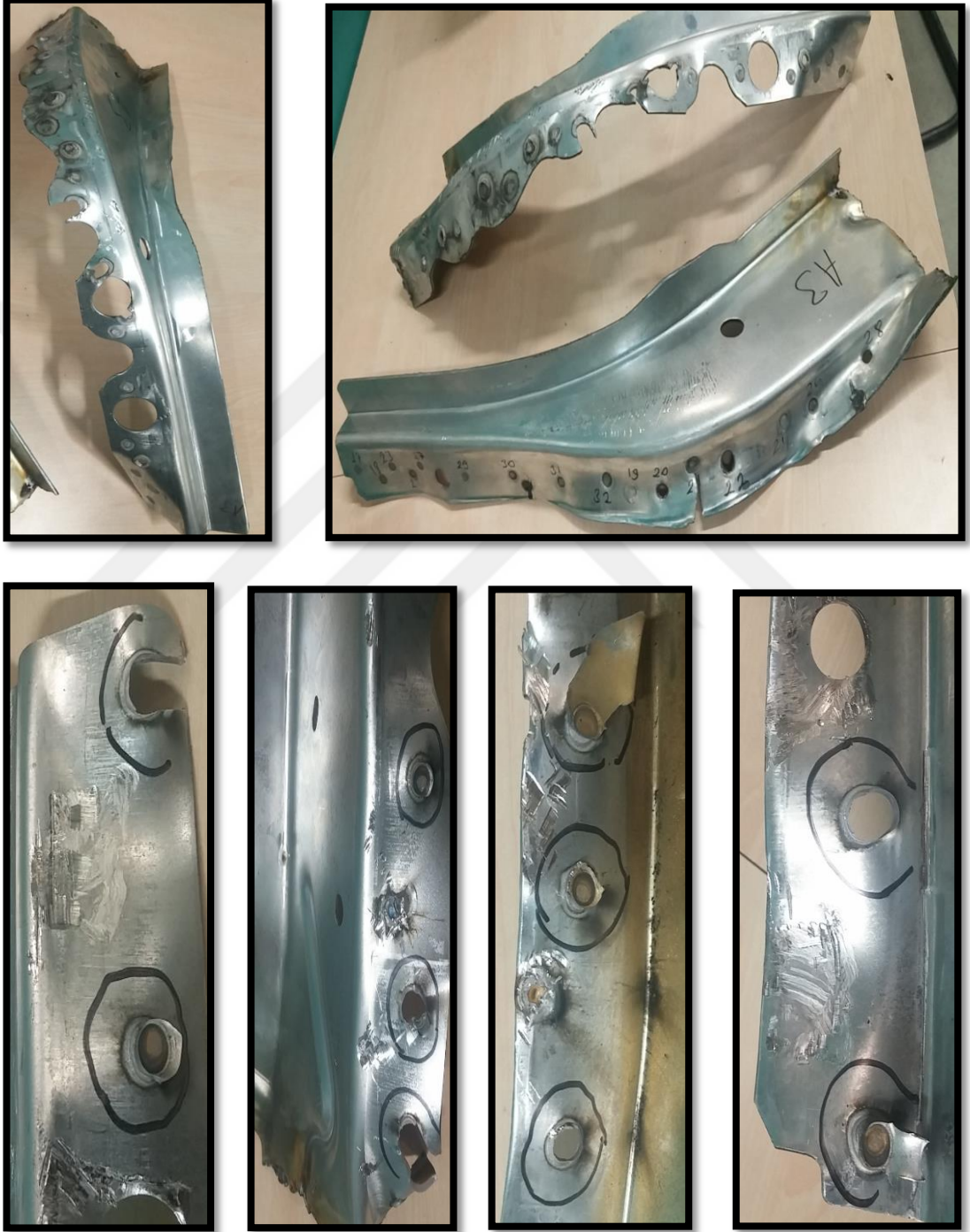
Şekil 5.3. Tahribatlı kontrol sonrası 32 deneyin uygulandığı deney numuneleri
