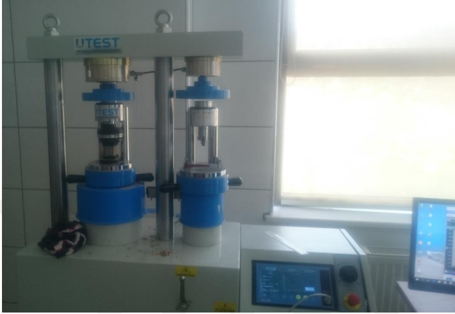
Şekil 4. 2. Tek eksenli basınç dayanımı testine tabii tutulan DT6 kod'lu numunenin görüntüsü
