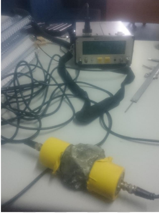
Şekil 4. 1. Ultrases deneyi yapılan DT2 kod'lu numunenin görüntüsü
