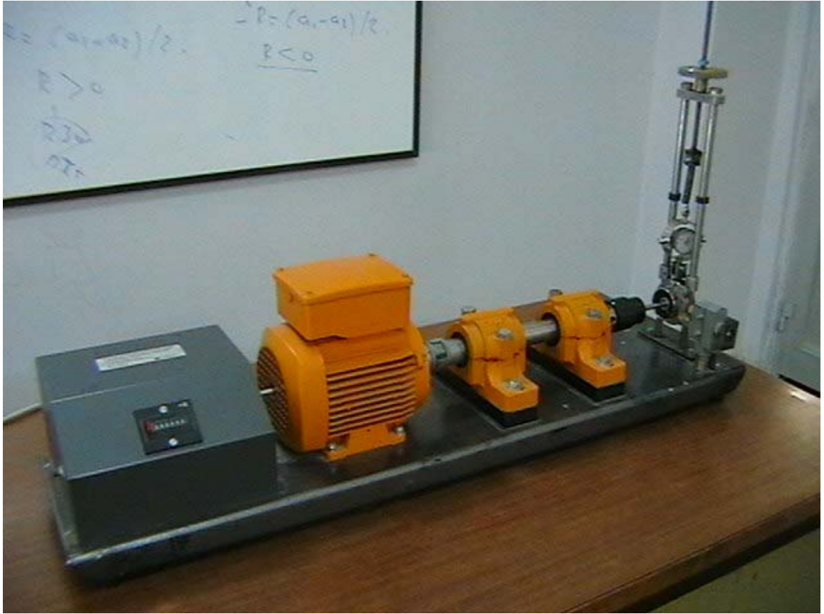
Şekil 3.44. Dönen eğilmeli ankastre kiriş türü yorulma test cihazı – (I)
