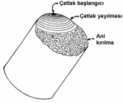
Şekil 3.24. Çatlak başlangıcı, yayılma ve ani kırılma bölgeleri (Meyers, Chawla, 1999).
