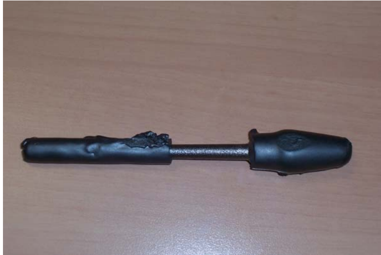
Şekil 3.42. Kumlama işlemi uygulanmış deney numunesi
