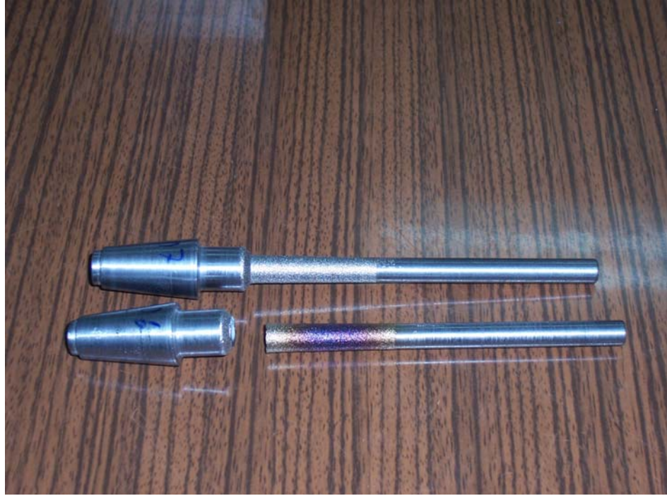
Şekil 4.6. EDM numunelerinin test öncesi ve sonrası
