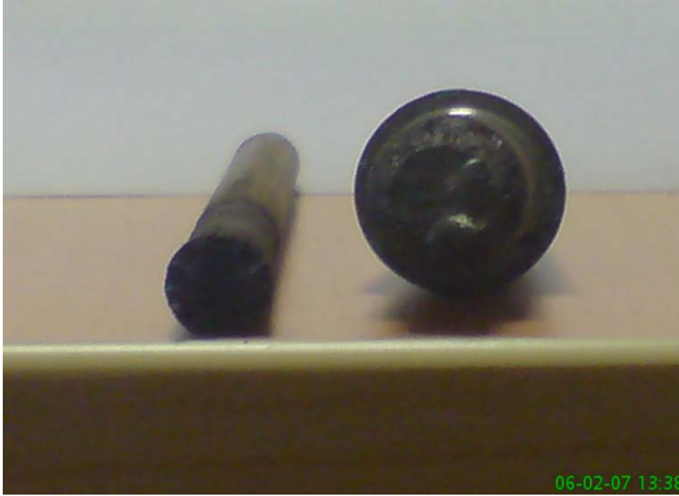
Şekil 4.8 Kimyasal Aşındırmaya tabi tutulmuş numunenin kesit görüntüsü
