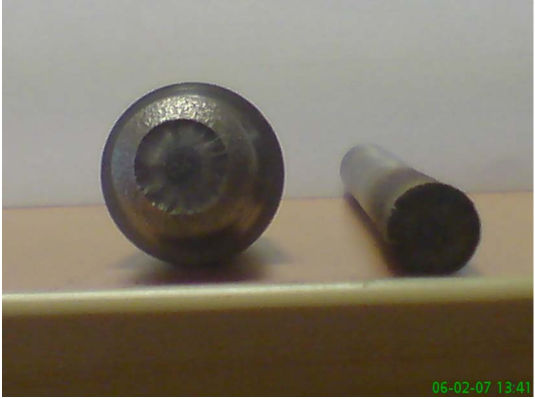
Şekil 4.3 Kırılan Numunenin Kesit Görüntüsü
