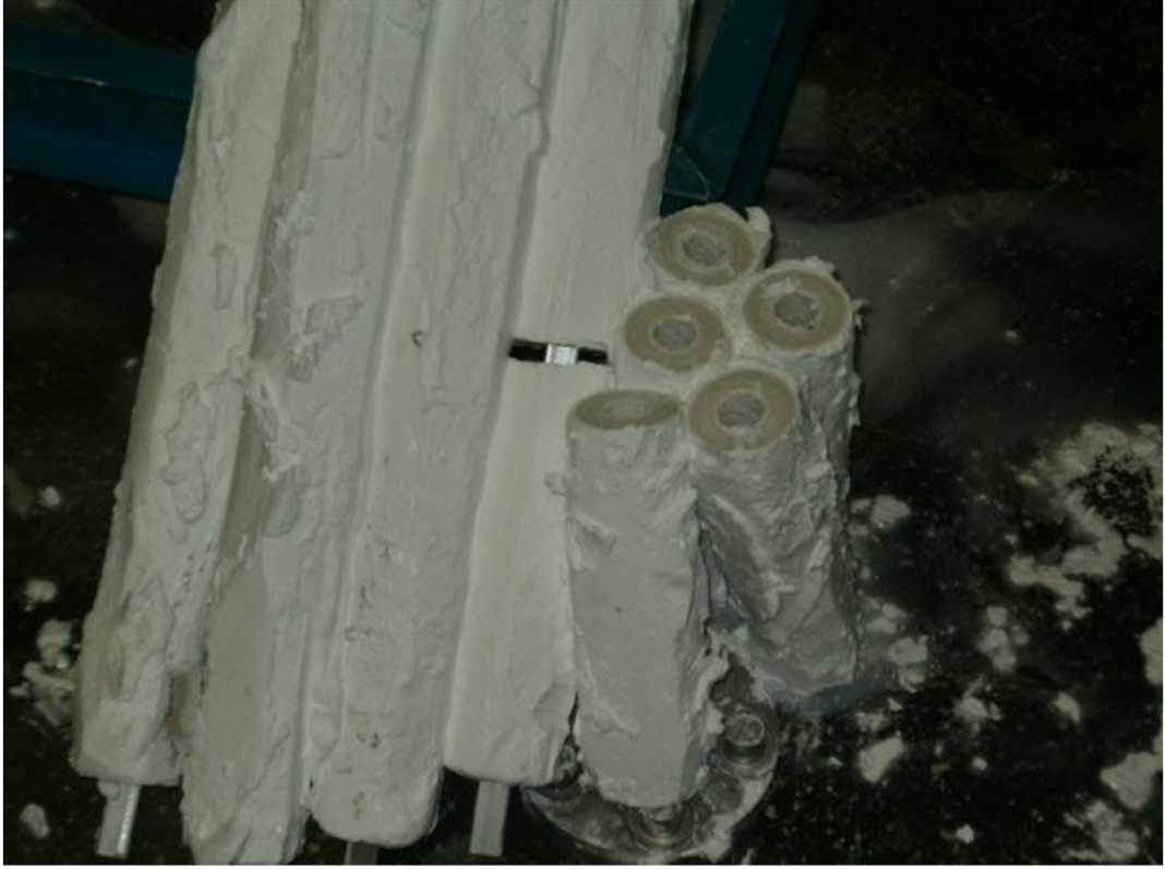
Şekil 2.38: Sudaki Kireç Yüzünden Tıkanmış Kartuş Filtre Seti (Anonim, 2006a)
