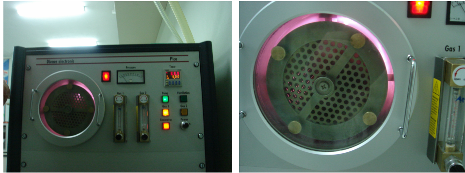
Şekil 3.21. Argon Plazmanın Numuneye Uygulandığı An
