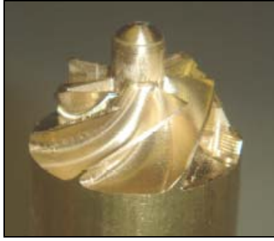
Şekil 3.7 Kompresörün 5 eksenli frezeleme ile üretim testi (çap 20 mm).
