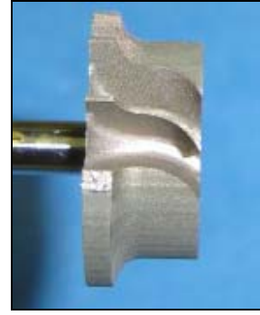
Şekil 3.8 Türbinin 3 eksenli EDM yöntemi ile üretim testi (çap 26 mm).
