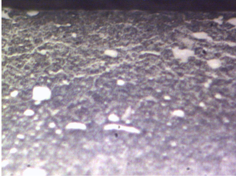
Şekil3.10. 7saat, 1.5mbar gaz basıncı ile plazma nitrülenmiş numune mikroyapısı (2-A)
