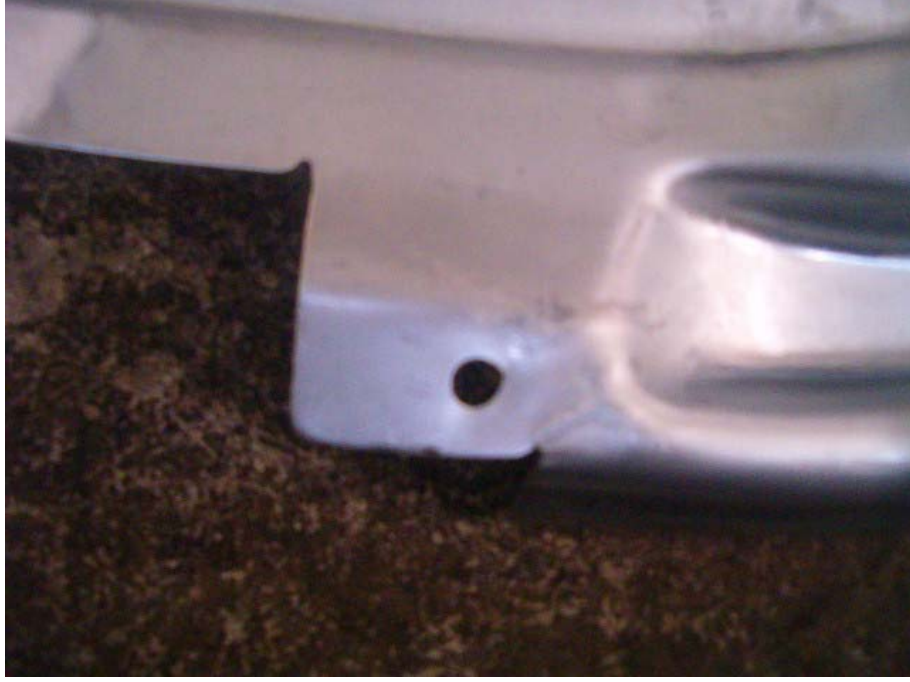
Şekil 3.18. Deneysel Çalışmada Kullanılan Sac Parça Referans Aşınmış Zimba ile İşlem Görmüş Delik Detay Resmi
