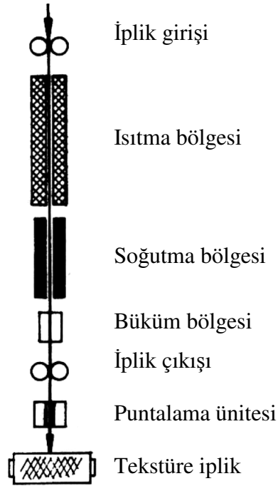
Şekil 2.43 Yalancı büküm tekniğinin şematik gösterimi (Acar, 1989)
