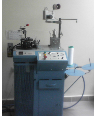
Şekil 3.20 POY örme makinesi
