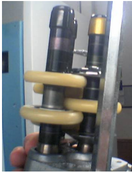
Şekil 3.12: Büküm kısmındaki büküm aparatı
