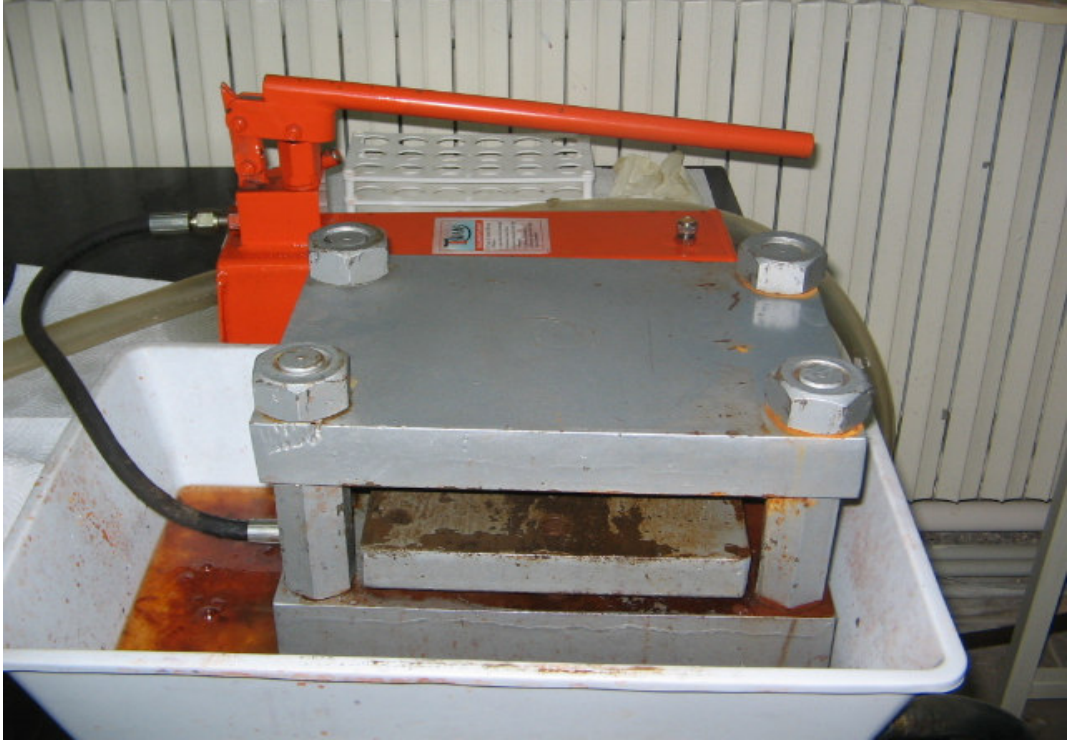
Şekil 3.5. Membran HÜcre Muhafazası
