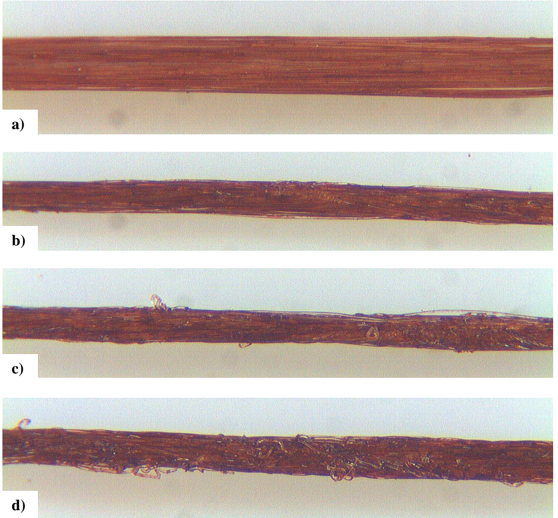
Şekil 4.44. İşlenmiş HTPET ipliklere ait optik mikroskop görüntüleri; a)HTPET Ham, b)HTPET10, c)HTPET15, d)HTPET20
