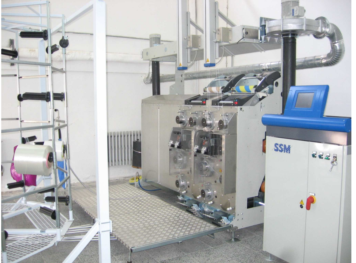
Şekil 3.2. Çalışmanın ikinci adımımda kullanılan hava-jetli tekstüre makinesi
