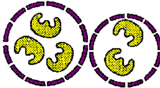
Şekil 2.3.4.2.5.1. Mikrokapsülleme ile enzim immobilizasyonu
