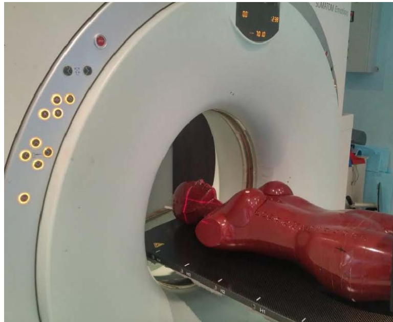
Şekil 7: BT cihazında, sırtüstü masaya düz pozisyonda rando fantom (Uludağ Üniversitesi Tıp Fakültesi, Radyasyon Onkolojisi Anabilimdalı, Ocak 2017)
