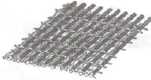
Şekil 1.32. Tek yönlü dokuma kumaş yapısı (Reinhart 1987)
