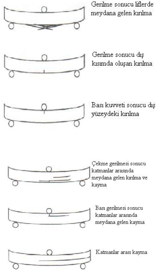
Şekil 2.12. Üç noktalı eğilme testinde meydana gelebilecek hata mekanizmaları (Hodgkinson 2000)
