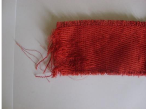
Şekil 3.4. Kumaşın çözümlü yönündeki test numunesi
