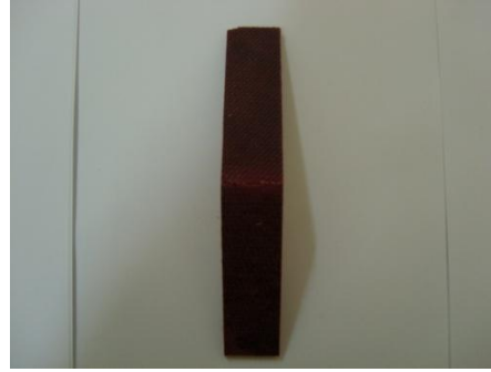
Şekil 3.20 Çözüğü yönü test numunesine ait deformasyon şekli
