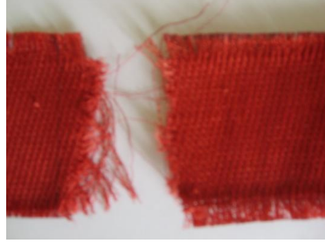
Şekil 3.5. Kumaşın atkı yönündeki test numunesi
