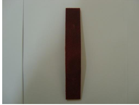
Şekil 3.24. 45^\circ doğrultusuna ait numunenin deformasyon şekli
