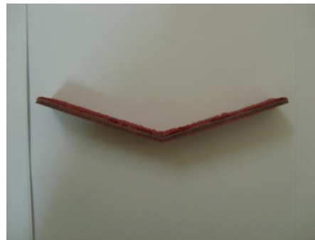
Şekil 3.21. Atkı yönünde test edilmiş numune
