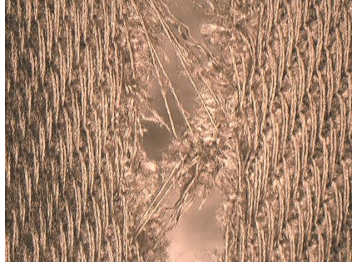
Şekil 3.11. Atkı yönünde test edilmiş numune
