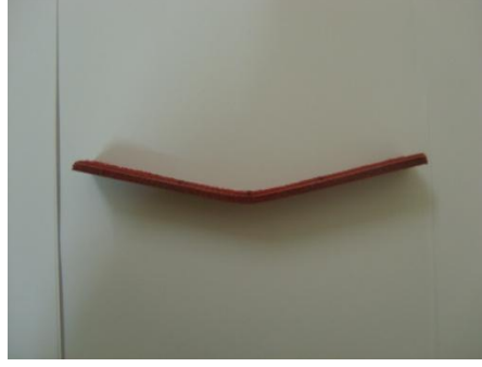
Şekil 3.23. 45^\circ doğrultusunda test edilmiş numune
