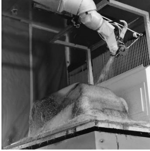
Şekil 1.8. Elyaf püskürtme işleminin uygulanması (Mazumdar 2002)
