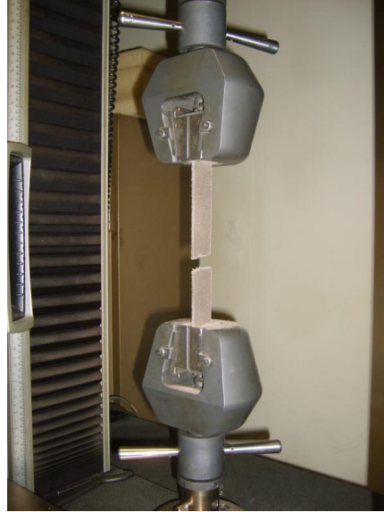
Şekil 2.8. Instron cihazında çekme testi yapılmış numune görünümü
