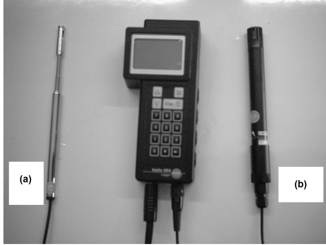
Şekil 3.4. Testo 454 veri toplama cihazı (a) hava hızı ölçüm probu (b) ortam sıcaklığı ve bağıl nem ölçüm probu
