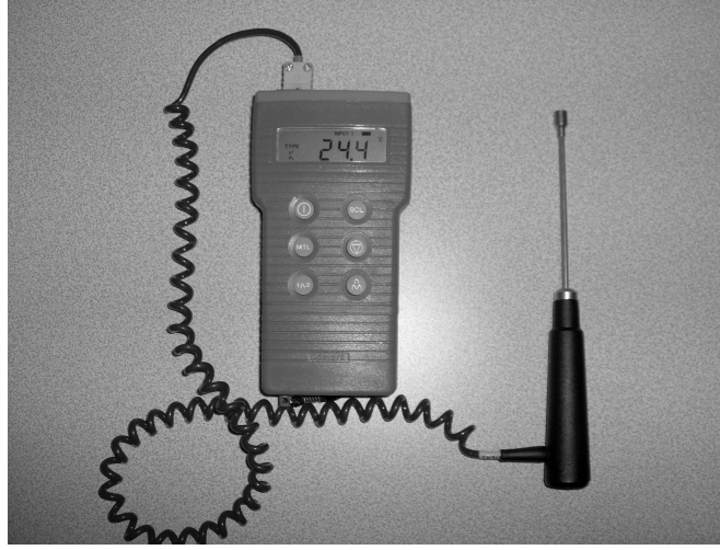
Şekil 3.5. Sırt bölgesi deri sıcaklığı ölçümünde kullanılan termometre ve yüzey sıcaklığı ölçüm probu
