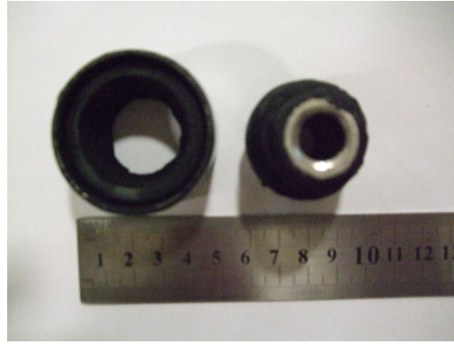
Şekil 4.6. Lastikten kopan kauçuk-metal burç
