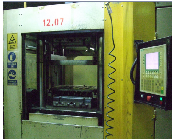
Şekil 3.4. Burç üretiminde kullanılan pres makinesi
