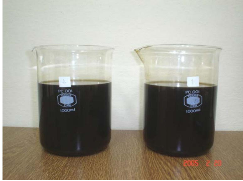
Şekil 3.9. Benzende çözündürülen asfaltın petrol eterinde çökme işlemine tabi tutulması.
