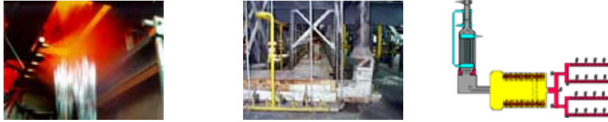
Şekil 2.1.4.1.Cam lifinin düzeden çekilmesi
