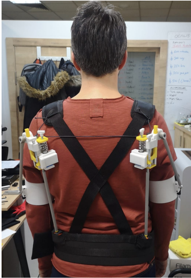
Şekil 3.24. Tekstil parçaları ile birlikte giyilebilecek şekilde üretilen dış iskelet sisteminin prototip hali
