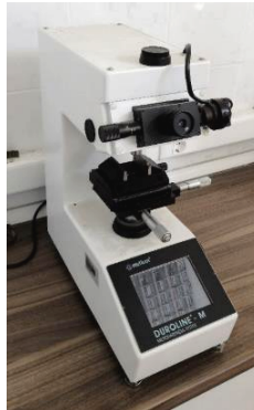
Şekil 3.7. Metkon markasına ait Vickers sertlik ölçüm cihazı
