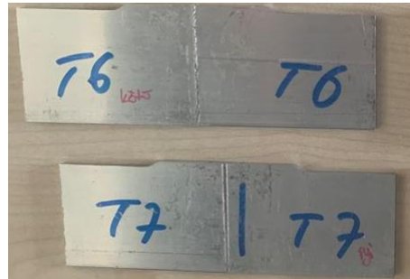
Şekil 4.21. 3 mm sertlik ölçümü yapılan numuneler
