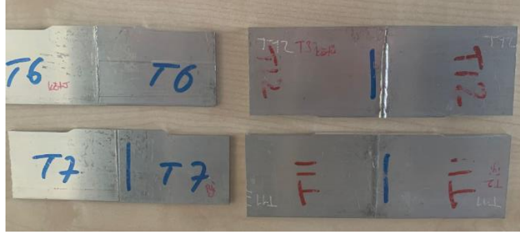
Şekil 3.8. Sertlik ölçümü yapılan numuneler (3mm ve 5 mm için)
