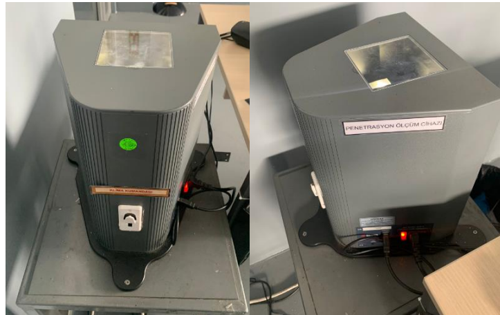
Şekil 3.9. STRUERS markalı penetrasyon ölçüm cihazı
