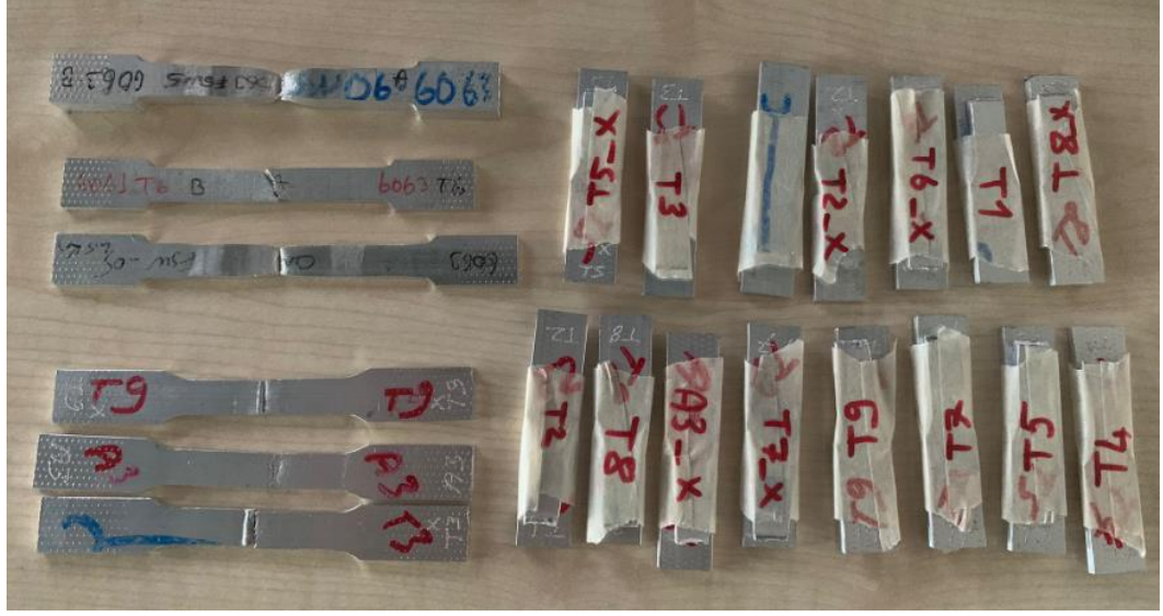
Şekil 3.6. Çekme deneyi sonrası numunelerin görüntüleri (Her iki kalınlık değeri için de)
