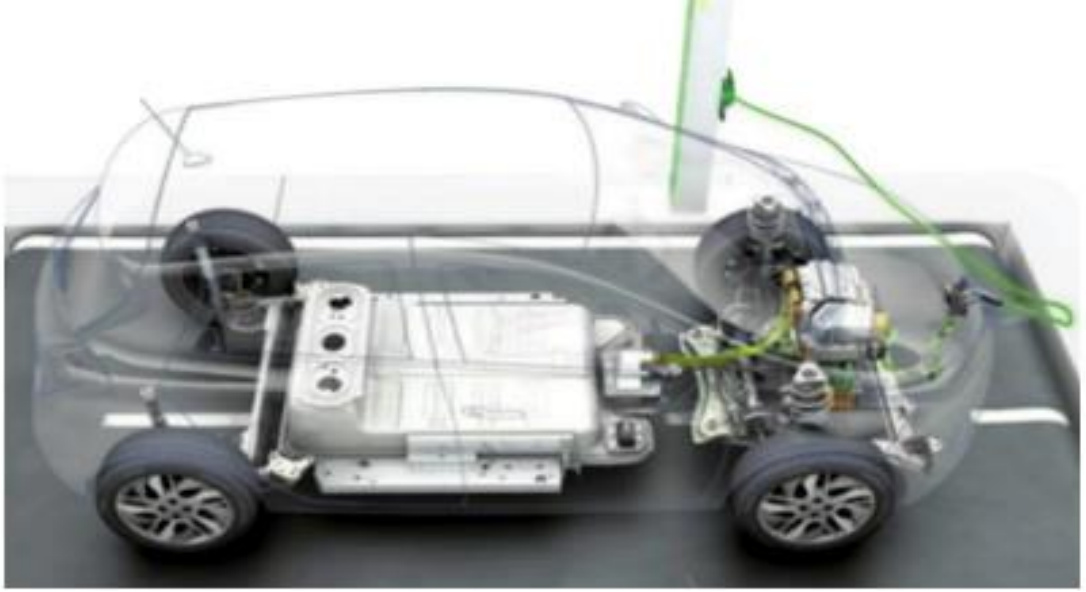
Şekil 2.31. Tümü-EA'ya örnek iç yapı (UKIP 2014)
