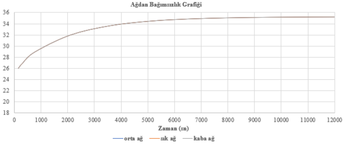
Şekil 3.9. Kaba, orta ve sık ağ yapısı için ağdan bağımsızlık grafiği
