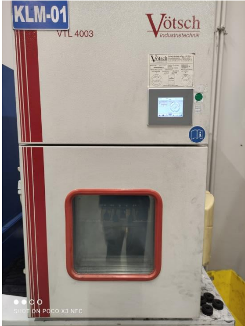
Şekil 3. 2. Yaşlandırma işlemi ünitesi
