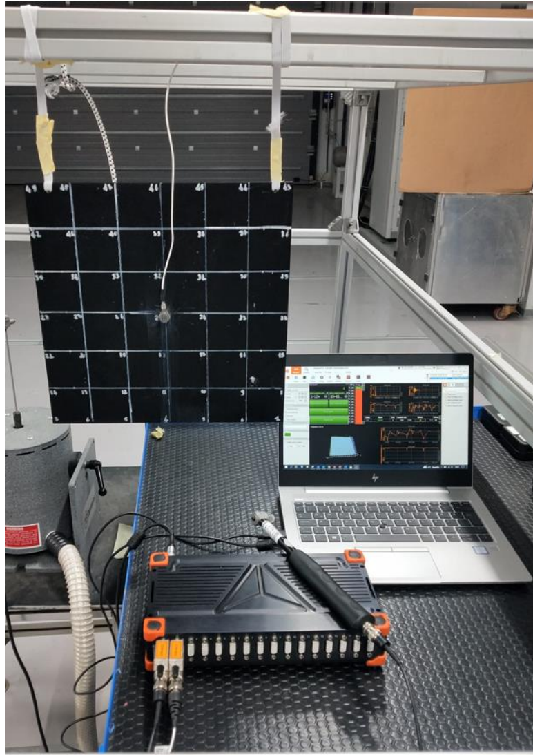
Şekil 4.11. Çekiç gezdirme modal test genel görünüşü
