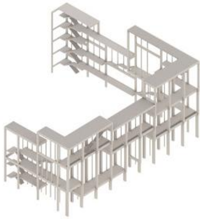
Şekil 3.28. Town House kuzey, güney ve batı cephesindeki sütunlar (Grafton Architects, 2019)
