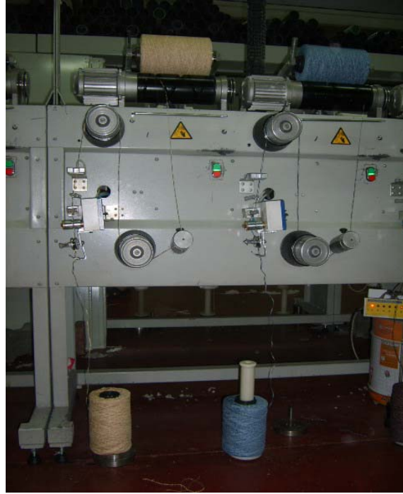
Şekil 2.24. Üretimi tamamlanan Chenille ipliğinin kopslardan çapraz bobinlere aktarılması esnasında bilgisayar kontrollü kapasitif algılayıcı ile denetlenmesi.
