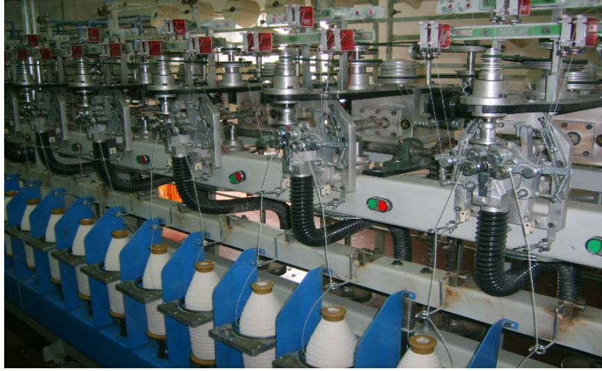
Şekil 2.23. Beş ayrı Chenille iplik üretim makinesinden elde edilen on adet Chenille ipliğinin üretim sonrası kopslara sarılması.
