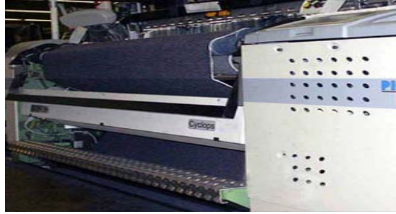
Şelil 2.10. Barco Vision Cyclops kumaş yüzey tarayıcısı ( www. barco.com/ vision/ downloads/ cyclops_e_screen.pdf ).
