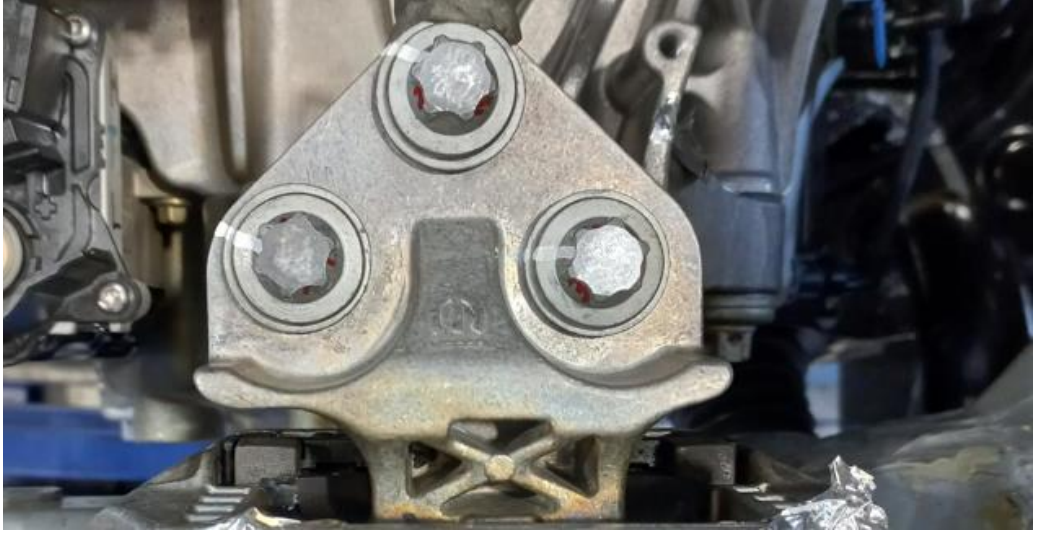
Şekil 4.14. MAST testi öncesi bağlantıların torklanmış hali
