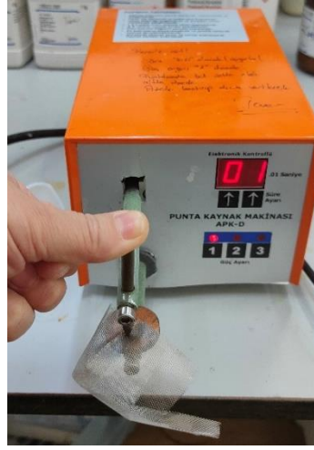
Şekil 3.3. Kaplama işlemine hazırlanan Sn/Sb/Ni kafesi
