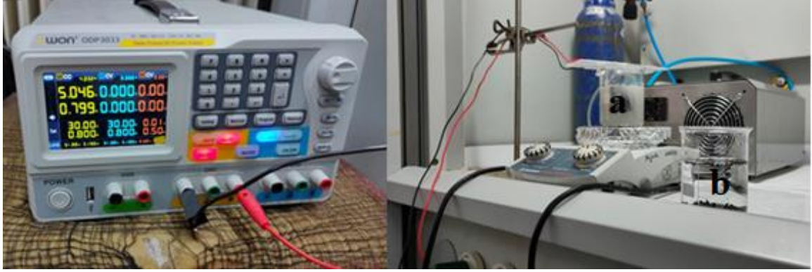
Şekil 3.7. Elektrokimyasal deney düzeneği a) doymun aktif karbonun elektrokimyasal rejenerasyonu, b) sadece elektrolit etkisiyle gerçekleşen doymun aktif karbon rejenerasyonu
