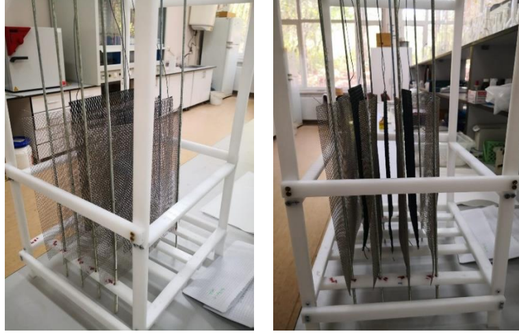
Őekil 3.5. Teflon Őase ierisindeki anot ve katota ait görünüřler
