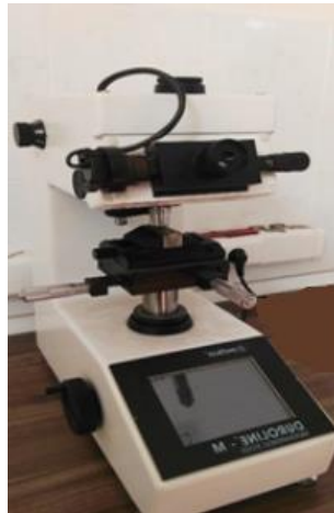
Şekil 3.9. Metkon Duroline-M marka sertlik ölçümünün yapıldığı cihaz
