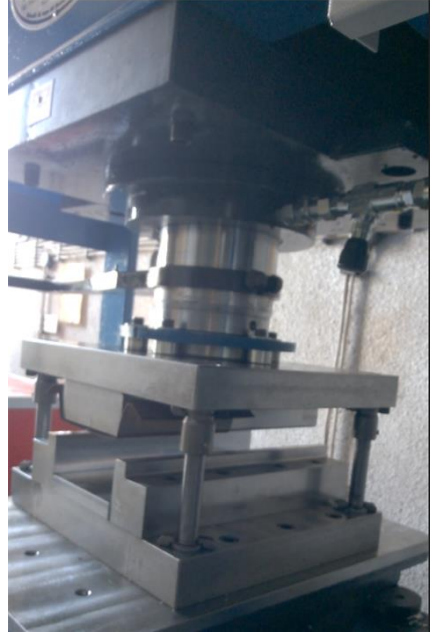
Şekil 3.2. U-profil kalıbına sahip hidrolik pres makinası
