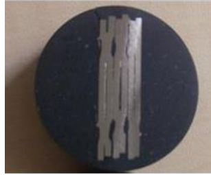
Şekil 3.7. Sıcak bakalite gömülmüş yüzeyi parlatılmış numune
