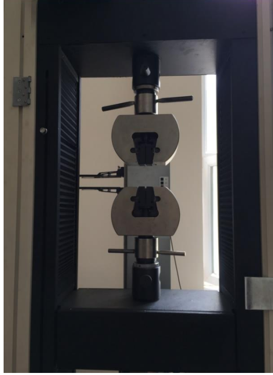
Şekil 3.8. Utest Universal marka çekme deneyinin yapıldığı cihaz
