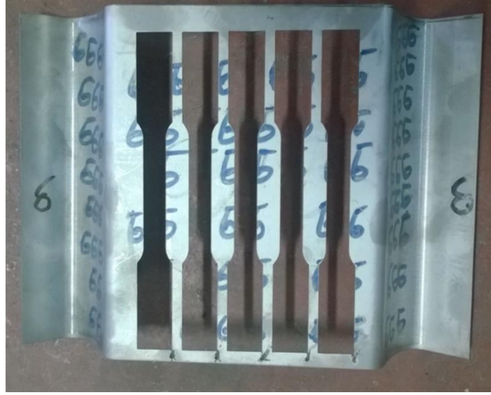
Şekil 3.5. Haddeme yönüne dik alınan numune
