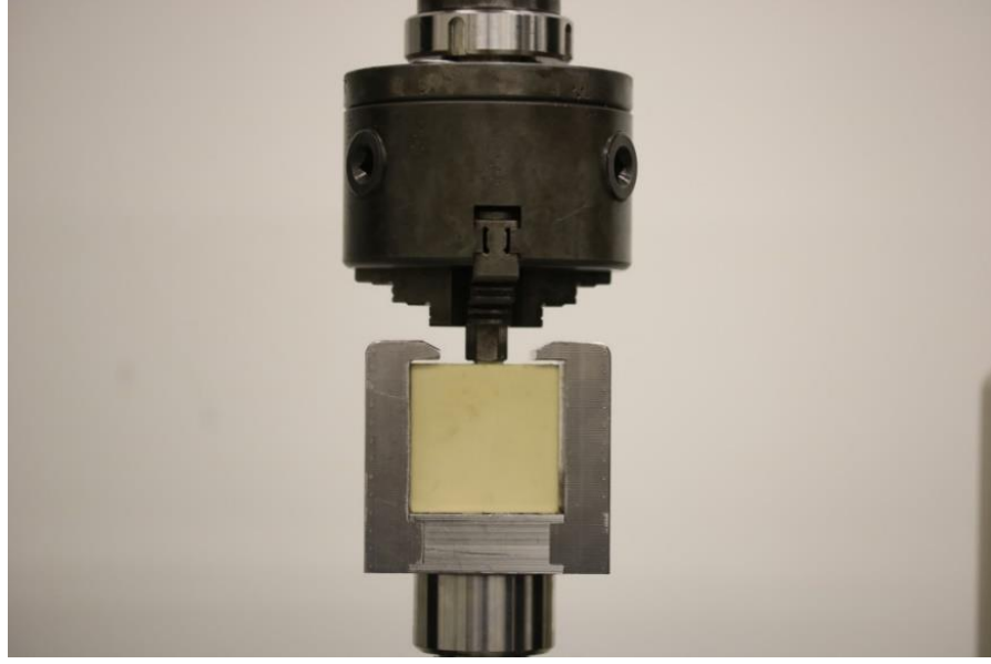
Şekil 4. 4. Çekme testi mekanizmasına yerleştirilen hatve uzunluğu 2,5 mm olan PEEK interferans vida
