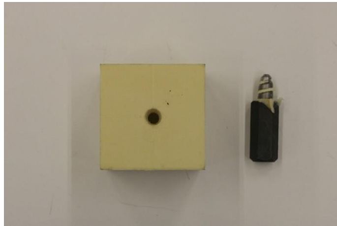
řekil 4. 26. Hatve uzunluęu 5,4 mm olan titanyum interferans vidanın ıktıęı poliüretan köpüęün son hali
