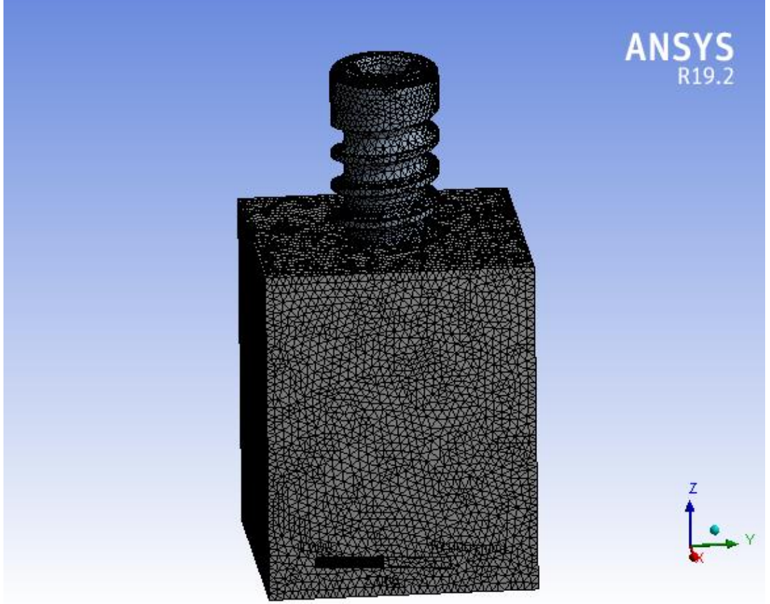
Şekil 4. 8. Hatve uzunluğu 2,5 mm olan interferans vida modelinin mesh işlemi
