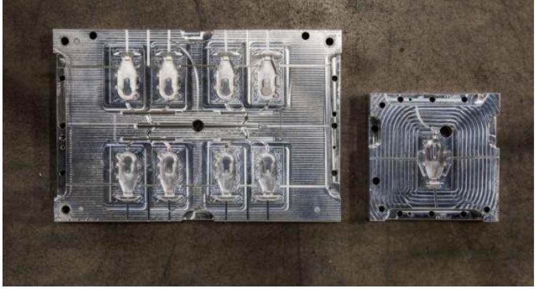
Şekil 3. 2. PEEK malzeme için üretilmiş plastik enjeksiyon kalıbı (Anonim, t.y.)
