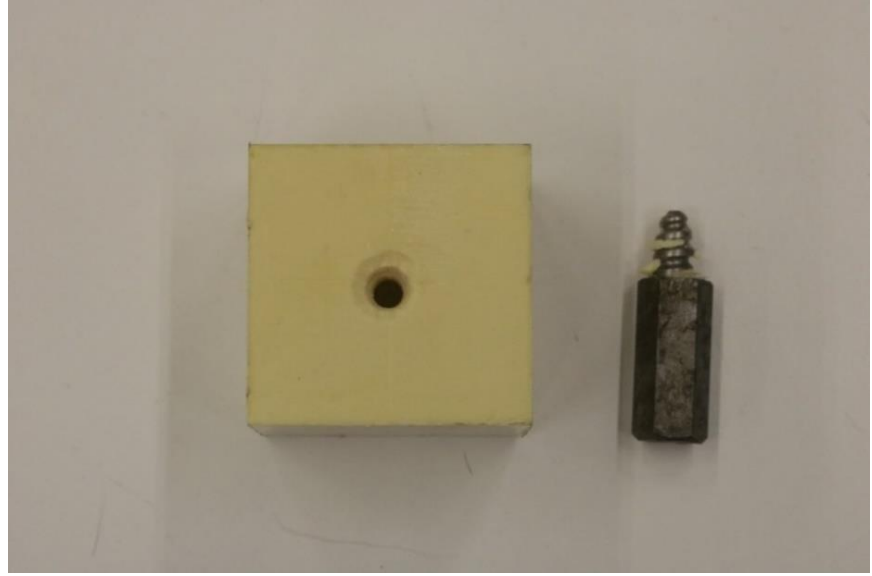
Şekil 4. 19. Hatve uzunluğu 3,6 mm olan titanyum interferans vidanın çıktığı poliüretan köpüğün son hali
