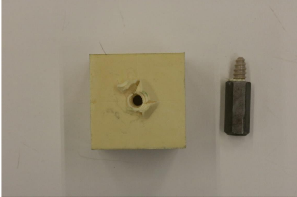
Şekil 4. 7. Hatve uzunluğu 2,5 mm olan PEEK interferans vidanın çıktığı poliüretan köpüğün son hali
