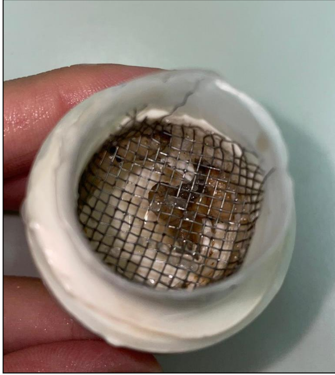
Şekil 3.22. Y-Olfaktometre içerisindeki G. mellonella larvalarının kafes düzeneği (Susurluk ve Doğan, 2023)
