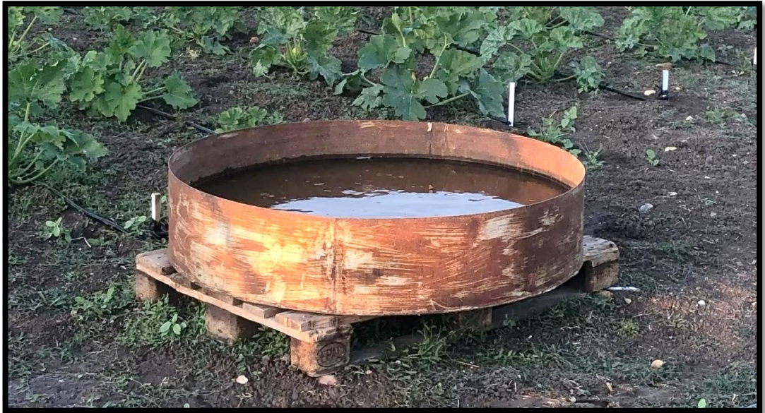
Şekil 3.3. Çalışmada kullanılan A sınıfı buharlaşma kabına ait görüntü
