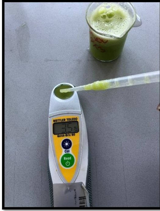
Şekil 3.8. Refraktometre’de SÇKM’nin belirlenmesi
