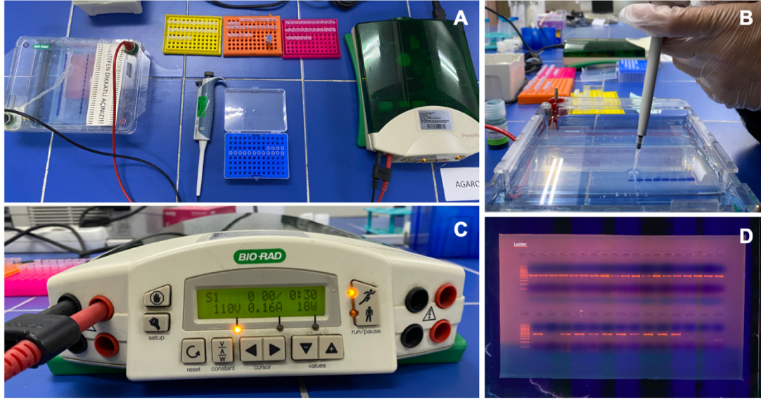
Şekil-6: Agaroz Jel Elektrofrezisi sürecine ait görüntüler A) Deney öncesi hazırlanan ekipmanlar B) Agaroz jele PCR örneklerinin yüklenmesi C) Elektroferez işlemi için cihazların çalıştırılması D) BCL2 Ekzon 3 bölgesine ait PCR ürünlerinin agaroz jelde yürütülmesinin ardından UV altındaki görüntüsü
