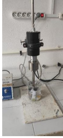
Şekil 3.2. Solüsyonların sonikasyon işlemi ve kullanılan ultrasonik cihazın görünümü
