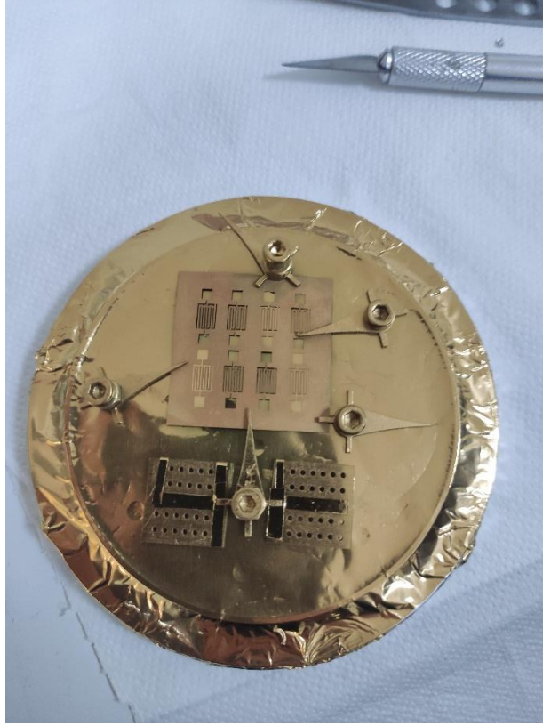
Şekil 3.6. Maske yardımıyla altın Schottky diyot kontaklarının alınması
