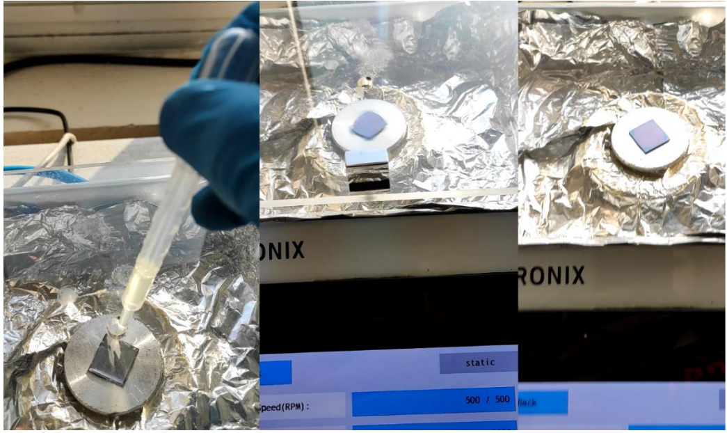
Şekil 3.5. Döndürme yöntemi (Spin coating) ile kaplama işlemi aşamaları
