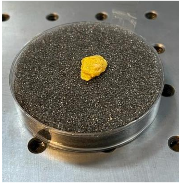
Şekil 2.14. TlInS 2 'nin yığın yapısı (bulk)
