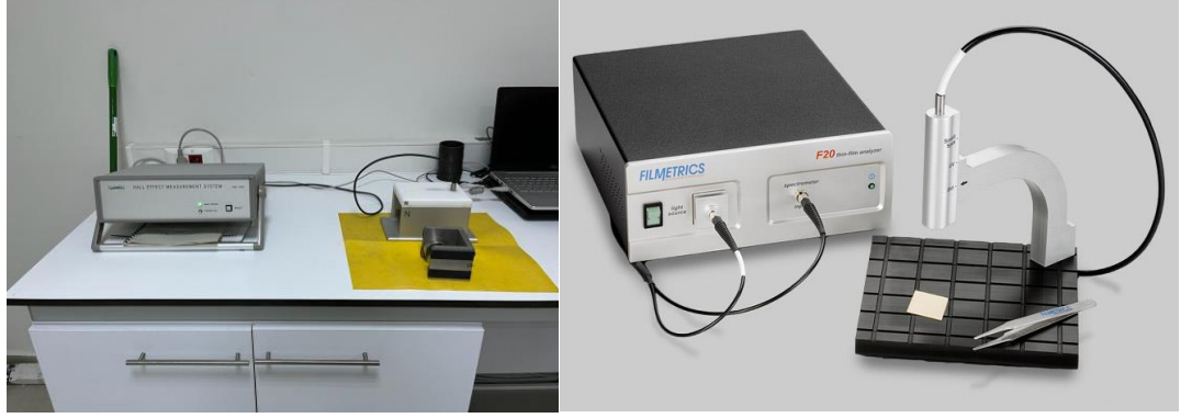
Şekil 3.8. Sol tarafta Ecopia HMS-3000 sağ tarafta PCB bağlantı ve manyetik akı yoğunluğu giriş sistemi, sağ tarafta ise Filmetrics F20 cihazı
