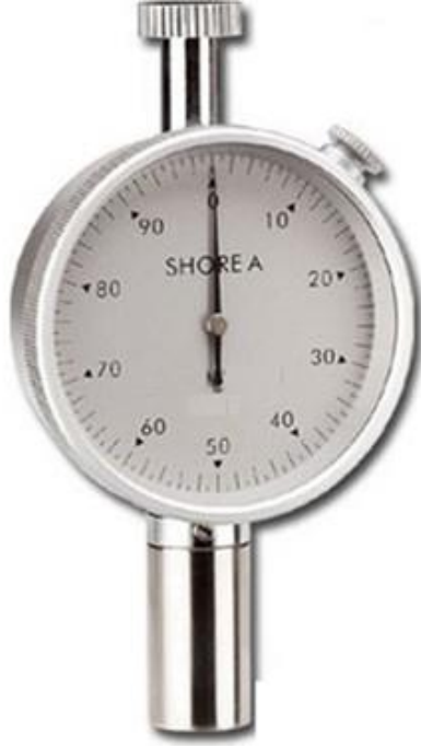
Şekil 3.2. Shore A test cihazı resmi. (Anonim, 2023)
