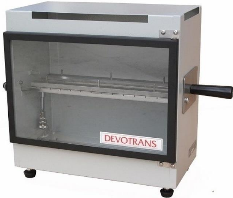
řekil 3.5. Yatay yanma test kabini resmi. (Anonim, 2023)
