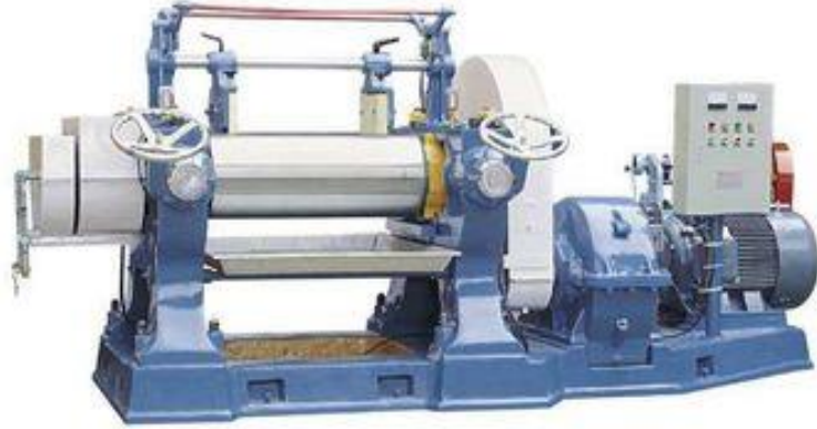
Şekil 2.41. Silindir karıştırıcı resmi. (Anonim, 2023)
