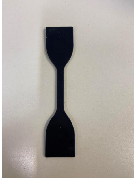
Şekil 3.8. Çekme – Kopma Testinde kullanılan test numunesi yukarıda verilmiştir.
