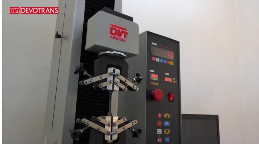
řekil 3.4. Mukavemet test cihazı resmi. (Anonim, 2023)
