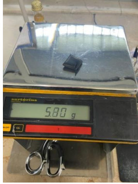
Şekil 3.6. Yukarıdaki resimde reolojik test esnasında alınan parçanın ağırlığı gösterilmektedir.
