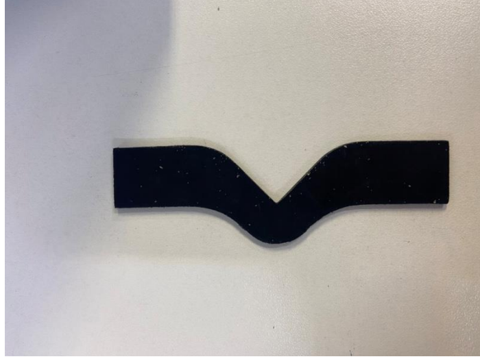
Şekil 3.9. Yırtılma testinde kullanılan test numunesi yukarıdaki resimde verilmiştir.
