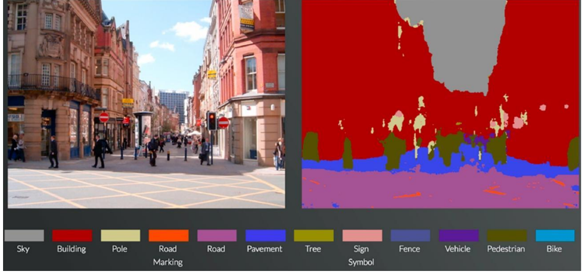
Şekil 3.7. Anlamsal bölütlemeye göre görüntüler üzerinde farklı objelerin tanımlanması ve sınıflara atanması (Badrinarayanan ve diğerleri)
