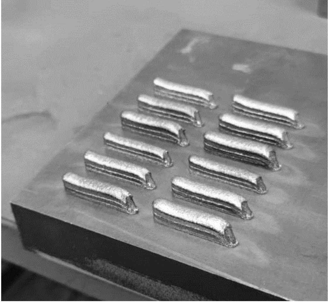
Şekil 3.6. Tek dikişli 10 katmanlı numuneler
