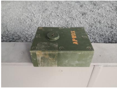
Numune 5: APWDX (Anti personel mayını- ahşap gövde-dikdörtgen prizmatik geometri)
