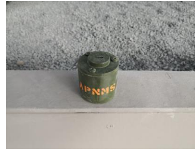
Numune 6: A APNMS (Anti personel mayını- PVC gövde-silindirik geometri)
