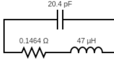
Şekil 3.66. ETQ-P4M470KFM kodlu bobinin oluşturulan eşdeğer modeli
