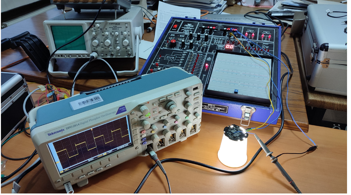
Ek Őekil 3.1. Anahtarlama frekansı ve darbe süresi geniřlięi ölçüm düzenegi
