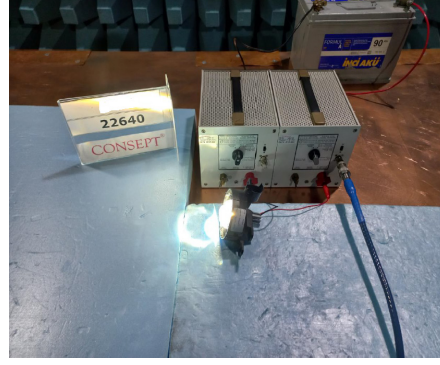
Şekil 3.93. Yarı yankısız odada gerçekleştirilen CE testi
