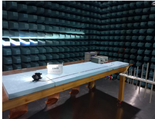
Şekil 3.94. Yarı yankısız odada gerçekleştirilen RE testi
