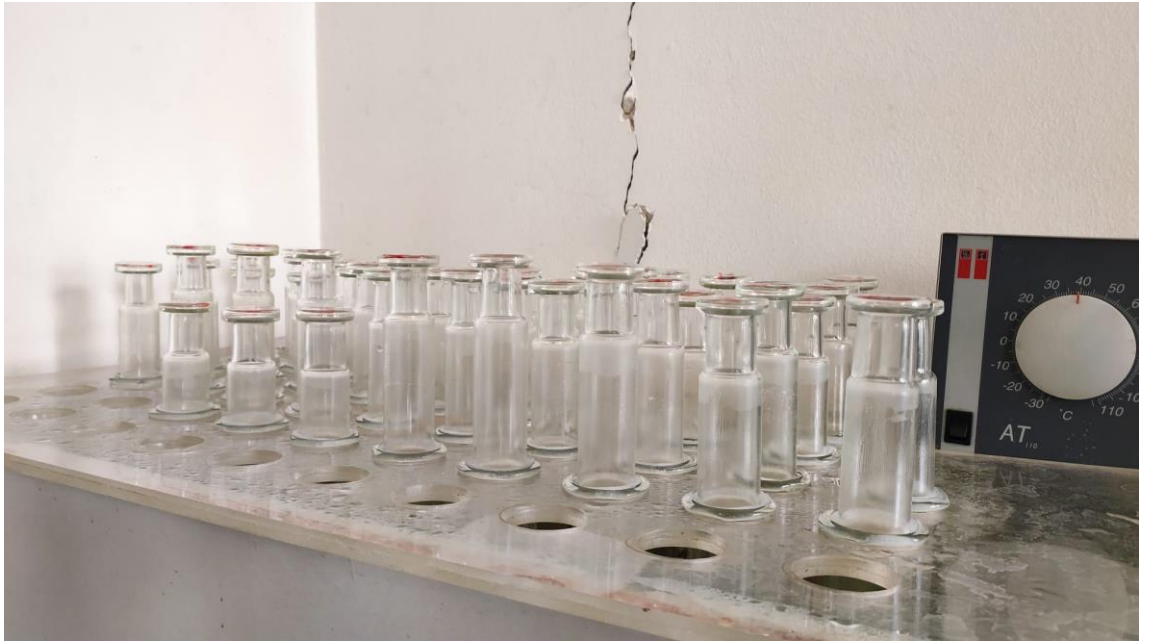
Şekil 3.2.1. Gaz üretim tekniğinde kullanılan cam şırıngalar ve inkübasyon havuzu.
