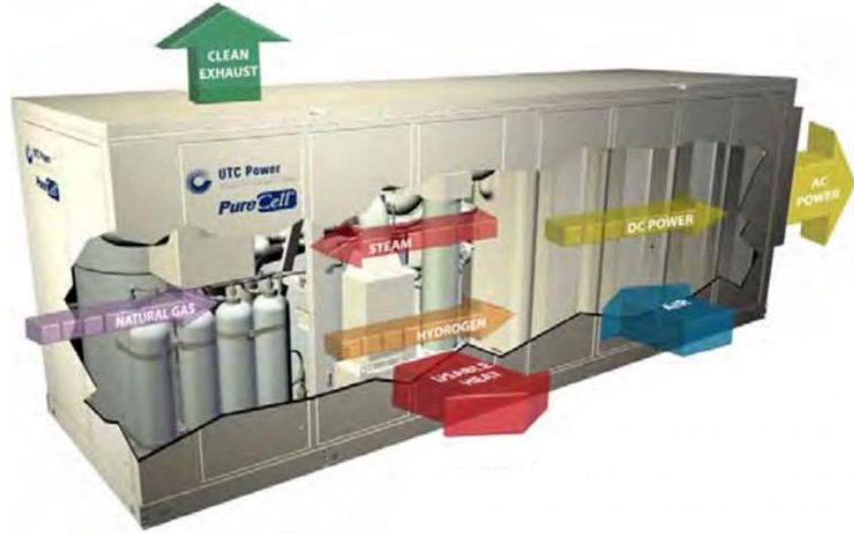
Şekil 2.20. Hidrojen yakıt pili güç sistemi (Short, 2011)
