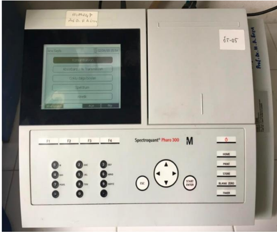
Şekil 3.6. KOİ sonuçlarının değerlendirildiği Spectroquant Pharo 300 M cihazı
