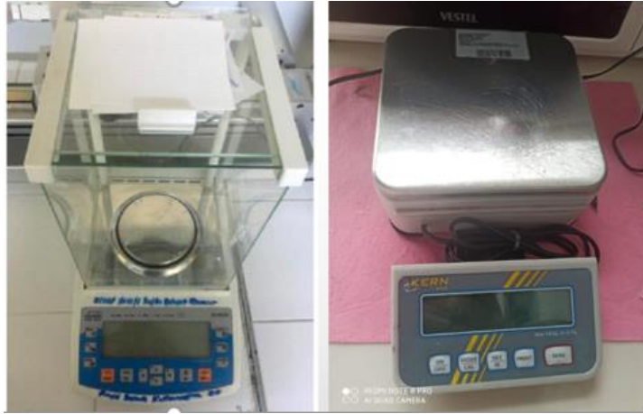
Şekil 3.3. Elektronik teraziler sırasıyla; RADWAG AS 220 R2, KERN PCD
