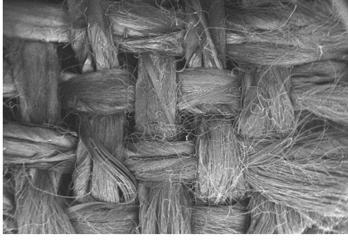
Şekil 4.13. Ham d şemelik kumařa ait SEM g r nt leri. A) 200 \mu\text{m} boyutunda g r nt  B) 20 \mu\text{m} boyutunda g r nt 
