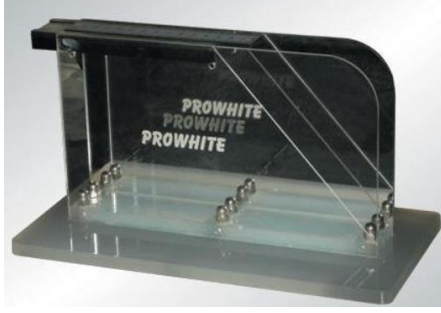
Şekil 3.10. Eğilme rijitliğinin ölçüldüğü Bursa Uludağ Üniversitesi cihazı
