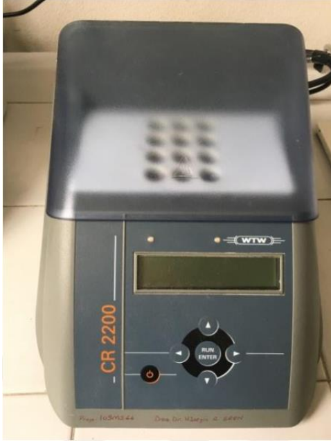
Şekil 3.5. KOİ ölçümlerinin yapıldığı WTW CR 2200 termoreaktör
