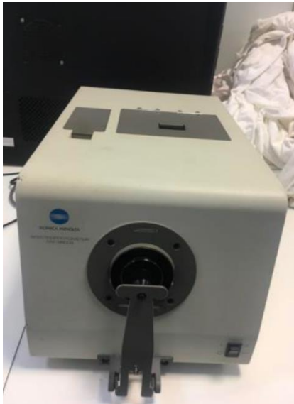
Şekil 3.12. Renk ve renk farklılığının ölçüldüğü cihaz Konica Minolta Spectrophotometer CM-3600D
