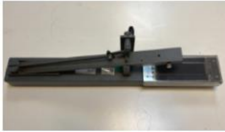
Şekil 3.9. Sürtme haslığının yapıldığı James Heal marka Crockmeter
