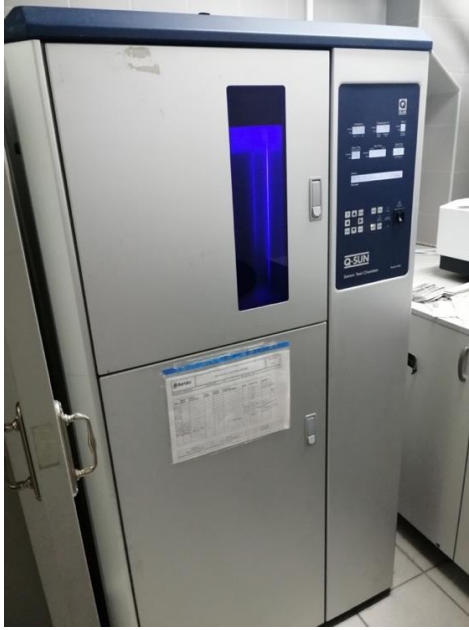
Şekil 3.8. Işık haslığı testlerinin yapıldığı Q-SUN Xenon Test Chamber cihazı
