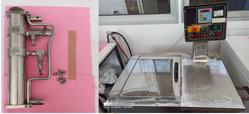
Şekil 3.2. Yüksek basınca dayanıklı boyama tüpü, bilyeler, mesh ve Rapid Xiamen Model H-12 yağ banyosu
