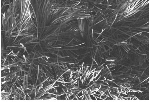
Şekil 4.9. 280 Bar 120 °C’de susuz boyanmış şönil kumaşa ait SEM görüntüleri. A) 200 \mu\text{m} görüntü B) 20 \mu\text{m} görüntü
