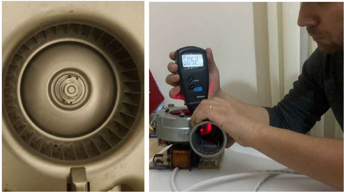
Şekil 3.7. Radyal Fan ve Fan Çarkının Takografle Devrinin Ölçümü
