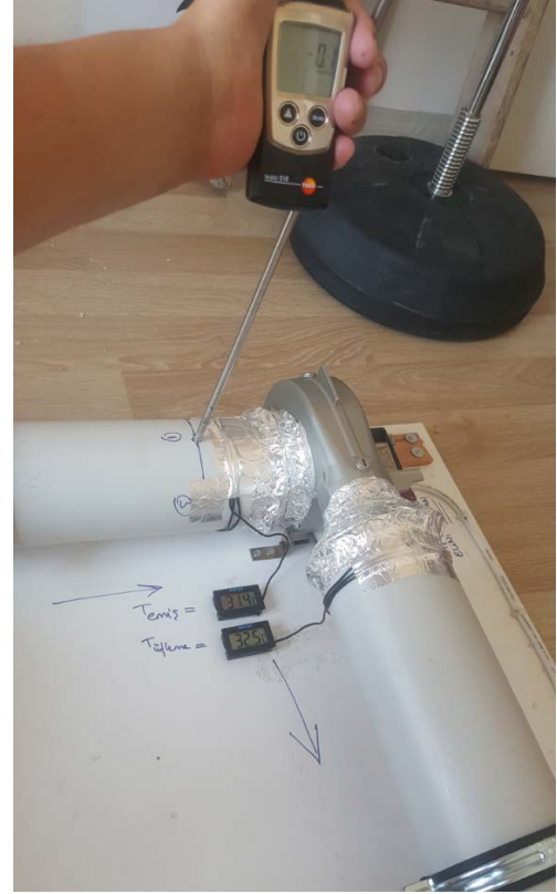
Şekil 3.10. Standarda Göre Pitot Tüpüyle Ölçüm Şeması ve Ölçüm Alımı
