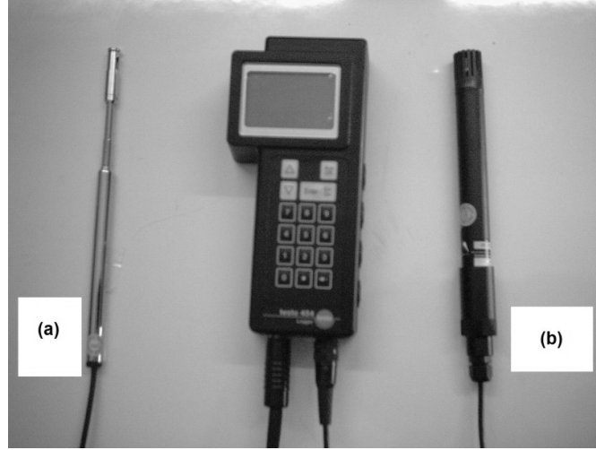
Şekil 3.3. Testo 454 veri toplama cihazı (a) hava hızı ölçüm probu (b) ortam sıcaklığı ve bağıl nem ölçüm probu
