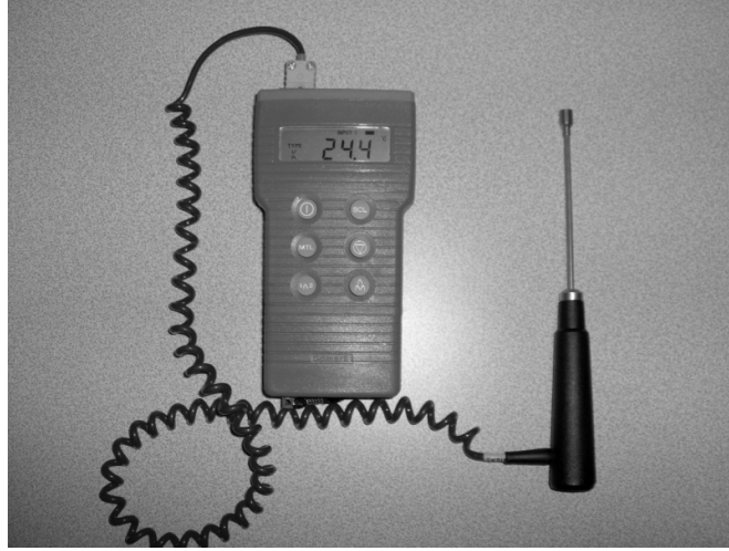
Şekil 3.4. Ense bölgesi deri sıcaklığı ölçümünde kullanılan termometre ve yüzey sıcaklığı ölçüm probu
