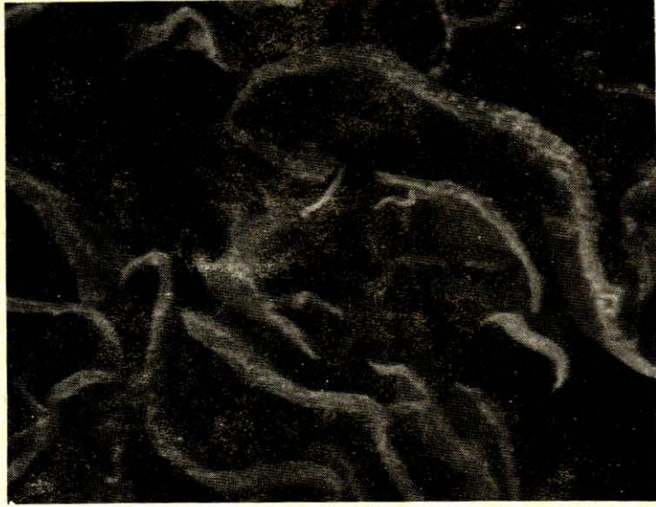
Şekil 13 — Lamel grafitli dökme demirde A tipi grafitlerin üç boyutlu SEM görüntüsü
