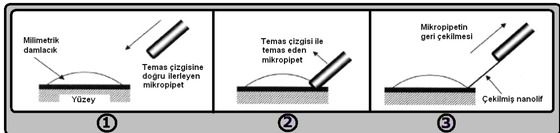
Şekil1.12. Çekim prosesi ile nanolif üretimi
