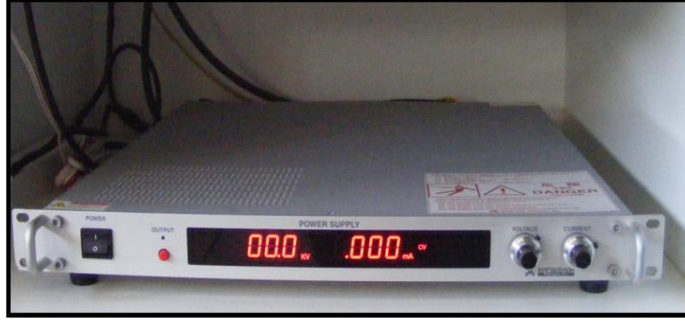
Şekil 2.1. Matsusada AU-50*1.2 DC yüksek voltaj güç kaynağı
