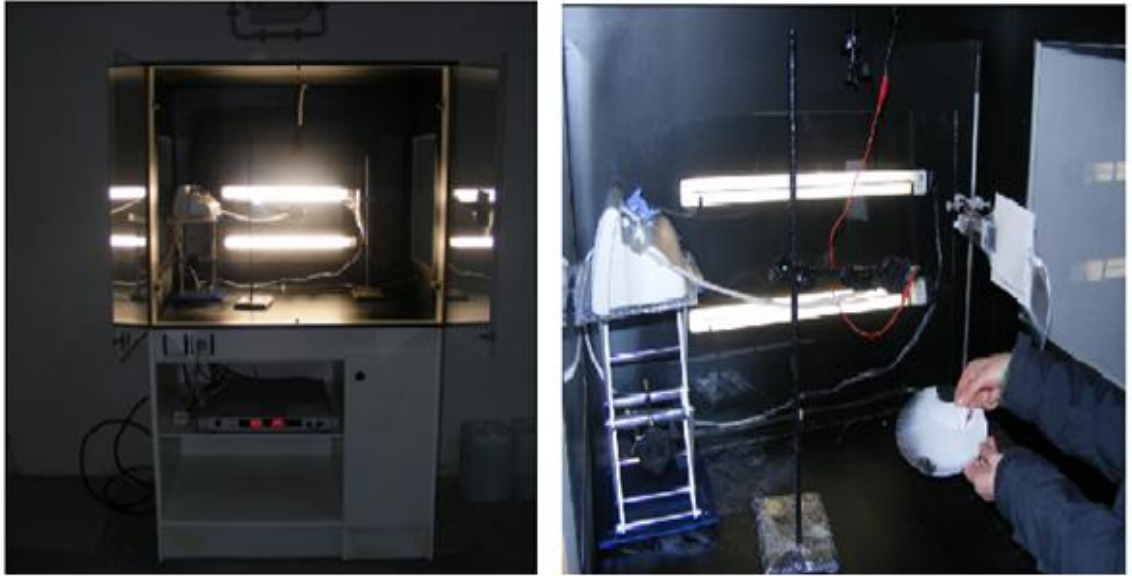
Şekil 2.17. Üretimler esnasında kullanılan elektro çekim düzeneği
