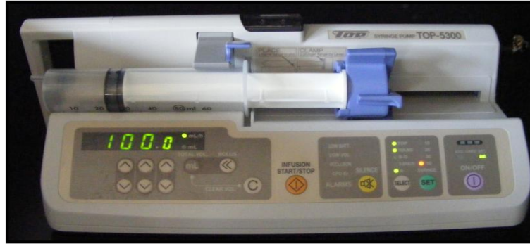
Şekil 2.2. Top-5300 model sıringalı perfüzyon pompası
