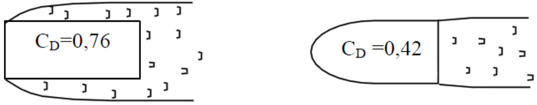
Şekil 3.6. Cismin geometrisine bağlı akım ayrılması (Schlichting 1979)
