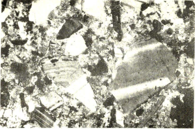
Foto 8 — ANDEZİTİK TÜF. Albit tipi ikizlenmeli ve zonar dokulu keskin köşeli andezin kırıntıları. Az miktardaki biyotit ve hornblend kloritleşmiştir. İncekesit K58, çapraz nikol, X25. Yeri: Taştepe kuzeyi.
