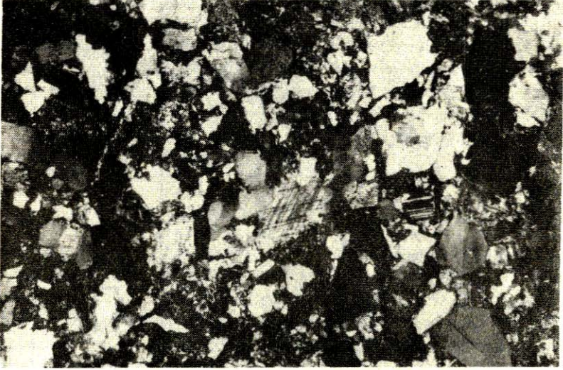
Foto 1 — GROVAK. Kloritli, karbonatlı ve serisitli matriks içinde detritik kuvars ve ikincil kalsit büyümeleri belirgindir. İncekesit K63, çapraz nikol, X50. Yeri: Dadalar Dere.
