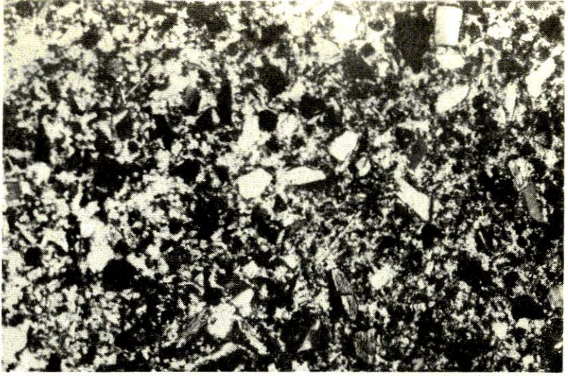
Foto 2 — FELDSPATLI, LİTİK KALK-ARENİT. Çok ince taneli serisit ve karbonatlı çimento içinde kuvars, az miktarda albit, çört ve yabancı kayaç parçaları izlenir. İncekesit K59, çapraz nikol, X50.
