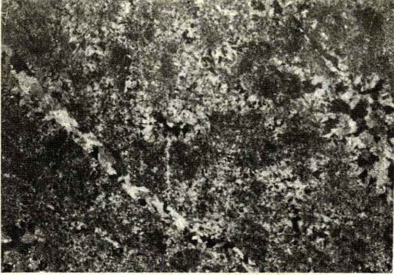
Foto 3 — KİREÇTAŞI. Kayaçtaki çatlak veya erime boşluklarını dolduran ikincil kalsit. İncekesit K5, çapraz nikol, X25. Yeri: Dadalar Dere.
