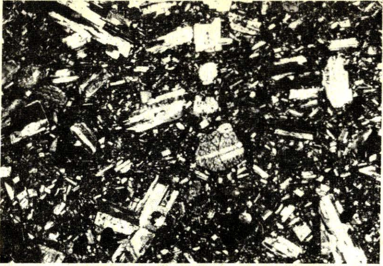
Foto 9 — BAZALTİK TÜF. Mikrolitik hamur içindeki hipidiyomorf, ikizli, kenarları yuvarlaklaşmış, kırıklı piroksen kristali. İncekesit K57, çapraz nikol, X25. Yeri: Çakmaktedere batısı.
